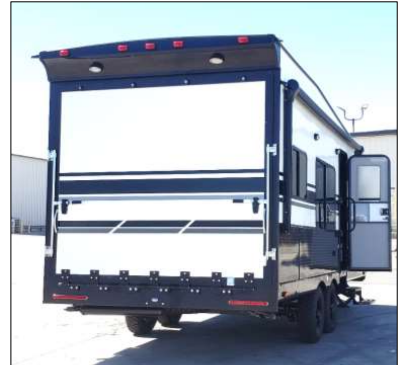
7-Foot Ramp Door
