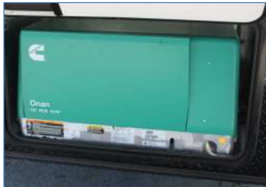
Onan 5.5KW Generator
