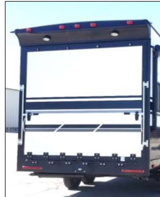
7-Foot Ramp Door
