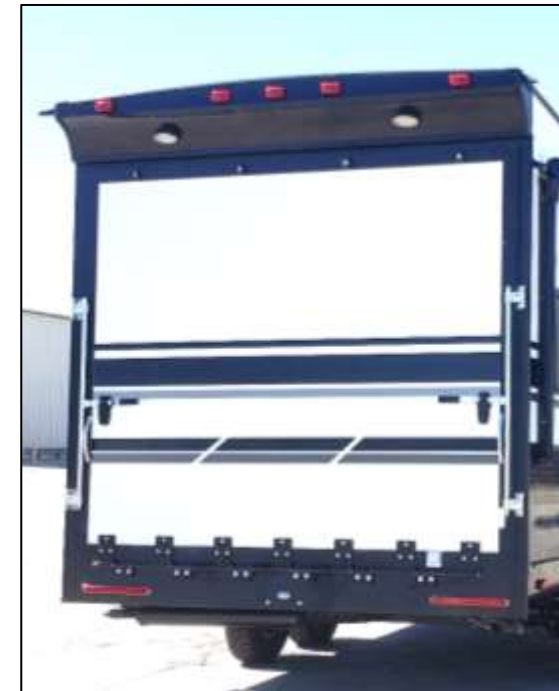
7-Foot Ramp Door
