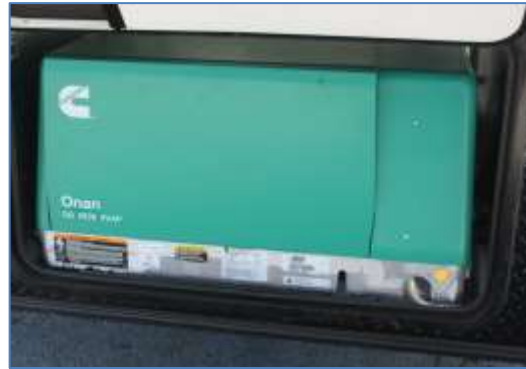
Onan 5.5KW Generator
