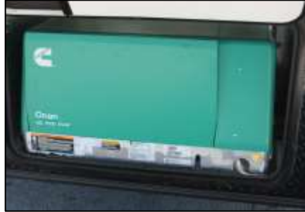
Onan 5.5KW Generator
