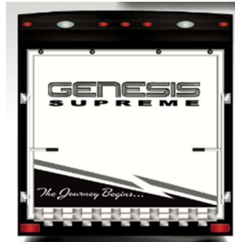
7-Foot Ramp Door
